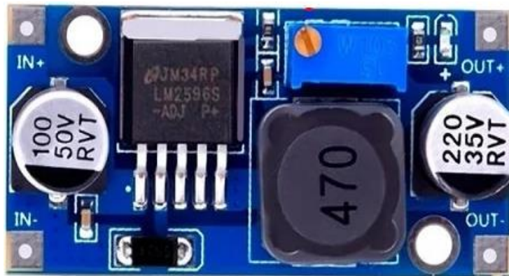
Fig. 5. DC-DC LM2596 Buck Converter
